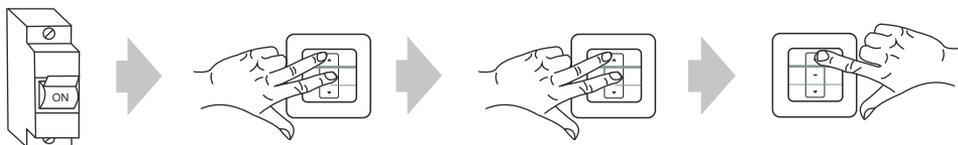
Nach dem Einlernen sollte man die Richtigkeit der Einstellung überprüfen, indem man den Motor mit Hilfe von Handsender in Betrieb nimmt. Um die Bewegungsrichtung des Motors zu ändern, sollte man den gewählten Kanal wie folgend neu programmieren: wenn der Motor mit „AUF + STOP und AB“ vorprogrammiert wurde und dessen Richtung umgekehrt ist, sollte man den Motor neu programmieren, indem man folgende Tasten drückt „AUF + STOP und die Taste AUF“
